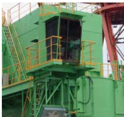
ジブクレーン運転室 水平または傾斜したジブ(腕)を持ち旋回可能な クレーン用運転室。
