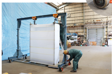
③ジャッキで調整しながらアイボルトで繋ぎます
