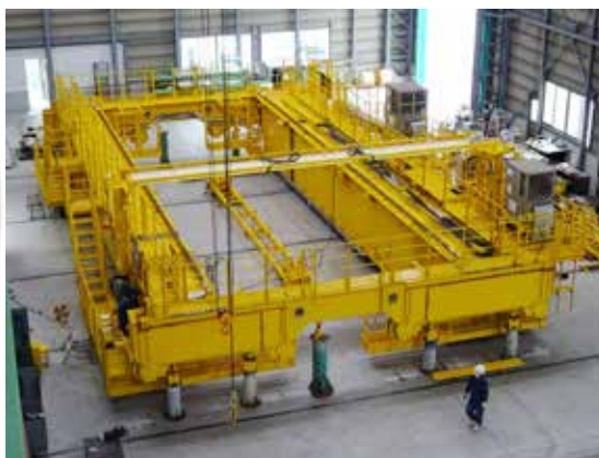
製鋼所向け大型クレーン
