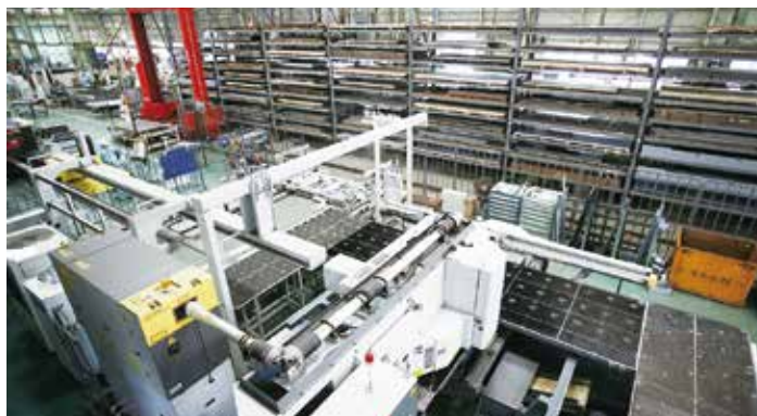
板金自動加工システム(西岡鉄工所設備) 材料製品棚との連動で無人運転が可能です。
