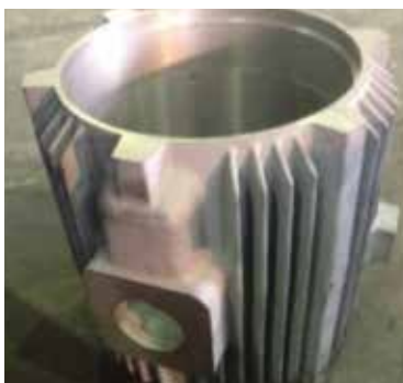
モーターフレーム(FC250、φ400mm×L370mm)
